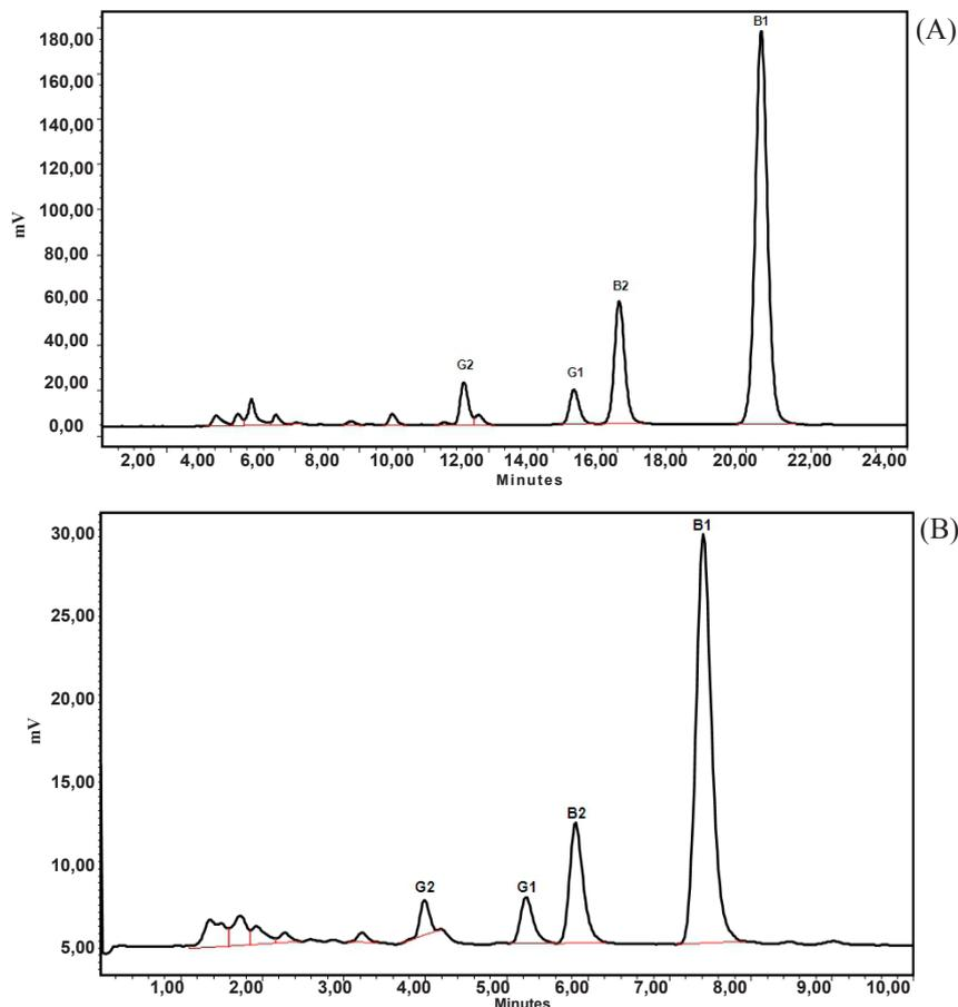
**Figura 1.** Cromatogramas de análise de aflatoxinas B1, B2, G1 e G2 em amendoim por CLAE em diferentes colunas (A = 5,0 μ e B = 2,4 μ).
